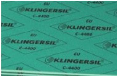
KLINGERSIL C-4400 auf Basis Aramidfasern, gebunden mit NBR, bringt mehr Sicherheit bei universeller Verwendbarkeit. Es besteht aus einer einzigartigen Matrix, die eine ausgezeichnete Kombination unterschiedlicher Eigenschaften bietet. - Universelles Hochdruck-Dichtungsmaterial - Dimensionsstabil - Einheitliche Materialzusammensetzung - Exzellentes Preis-Leistungsverhältnis - Geeignet für eine große Anzahl an Medien - Sehr gute Beständigkeit gegen Kältemittel
