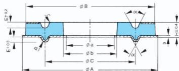
Megiflex-Scheiben sind einfache Standardelemente, die im Leicht- und Schwermaschinenbau sowie im Fahrzeugbau für elastische Lagerungen eingesetzt werden. Megiflex-Scheiben, die zu Federpaketen zusammengefaßt werden können, werden häufig als Pufferelemente bei Schienenfahrzeugen verwendet. Außerdem lassen sich Zug-Druck-Elemente davon zusammenstellen. Diese Hintereinanderschaltungen bewirken veränderliche Federkonstanten und somit Federwege.
