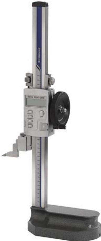
PROMAT Höhenmess- und Anreißgerät 300 mm digital 0,01 mm/0,0005 inch · digital · kräftiger Fuß mit geschliffener Standfläche · 5-stellige LCD-Anzeige · Messwertwahl in beide Richtungen · Nullstellung in jeder Position · mit Handkurbel · Anreißnadel HM-bestückt · das unempfindliche kapazitive Messsystem ermöglicht hohe Verfahrensgeschwindigkeiten und fehlerfreies und wirtschaftliches Messen bzw. Arbeiten
