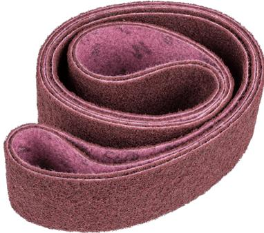
PFERD Vlies Langbänder VB 75/2000 A 180 M - Schleifmittel: Korund A - POLIVLIES-Korngröße 180 M = mittel (rotbraun). Universell zur Oberflächenbearbeitung von Metallen im stationären Einsatz geeignet, z. B. Beseitigen von Vorschleifspuren, Entfernen von Oxidation und leichte Entgratarbeiten. Erzielen mattierte und seidenmatte Oberflächen. Langbänder sind auf die am Markt gängigen Bandschleifmaschinen abgestimmt. Sie werden in ISO 2976 unter der Bezeichnung „Schleifbänder“ geführt.
