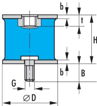
**5218 152 B 45NR11 M8 Rundlager Typ B 40x40 mm, mit Außen-/Innengewinde**
