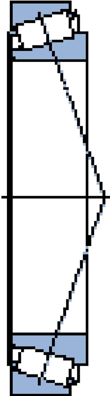
**30228 SKF Kegelrollenlager, einreihig**
