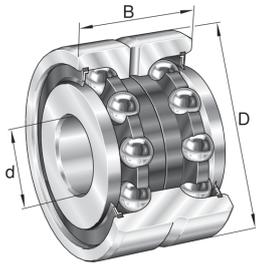
**ZKLN0619-2Z-XL INA Axial-Schrägkugellager ZKLN, zwei-reihig**
