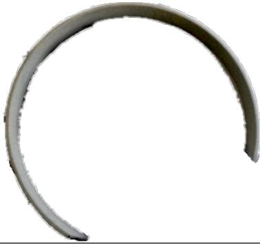
**GP7303800-T47 Führungsring für Kolben, 380,0x15,0x2,5x1173,2 mm**
