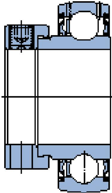
**YET 207 SKF Spannlager YET, Exzenterringbefestigung**
