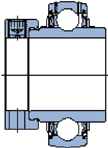
**YEL 208-2F SKF Spannlager YEL..2F, Exzenterringbefestigung**
