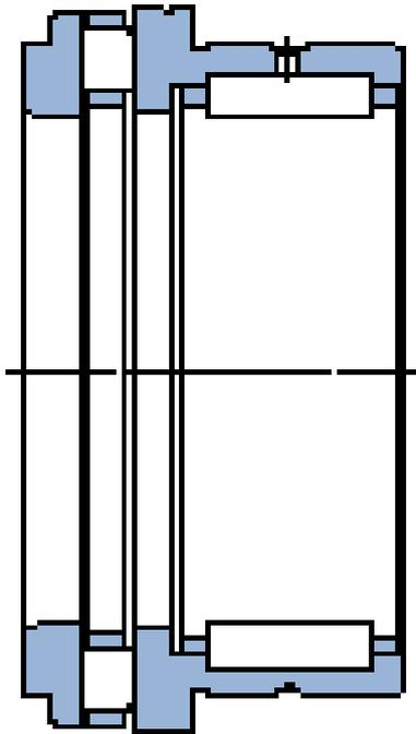
**NKXR 20 SKF Nadel-Axial-Zylinderrollenlager NKXR ohne IR**
