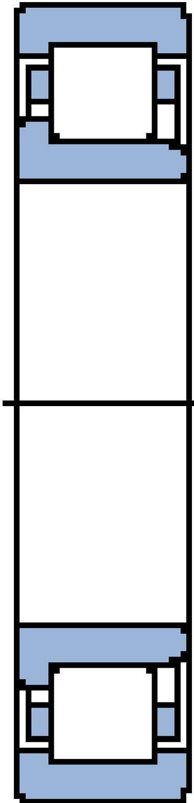
**NJ 2207 ECML/C3 SKF Zylinderrollenlager NJ, einreihig**
