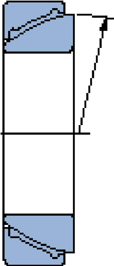
**GAC 45 F SKF Schräg-Gelenklager GAC..F, wartungsfrei**
