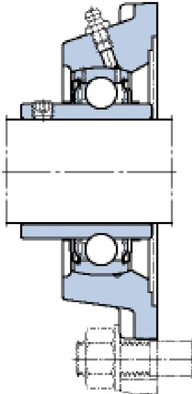
**FY 2.3/16 TF SKF Flanschlagereinheit FY..TF quadratisch, 4-Loch**
