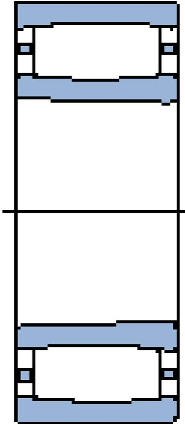
**C 2208 KTN9 SKF CARB Toroidalrollenlager**
