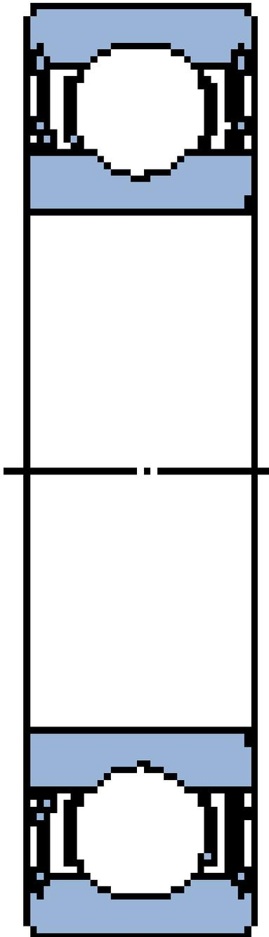
**6213-2RS1 SKF Rillenkugellager, einreihig**
