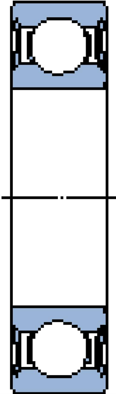
**6203-2RSL/C2GJN SKF Rillenkugellager, einreihig**
