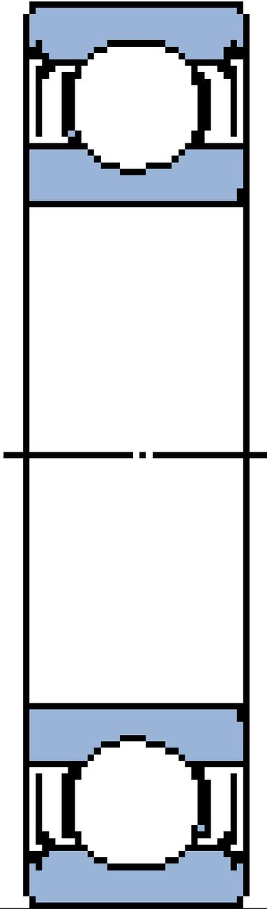
**6200-2Z/C2 SKF Rillenkugellager, einreihig**
