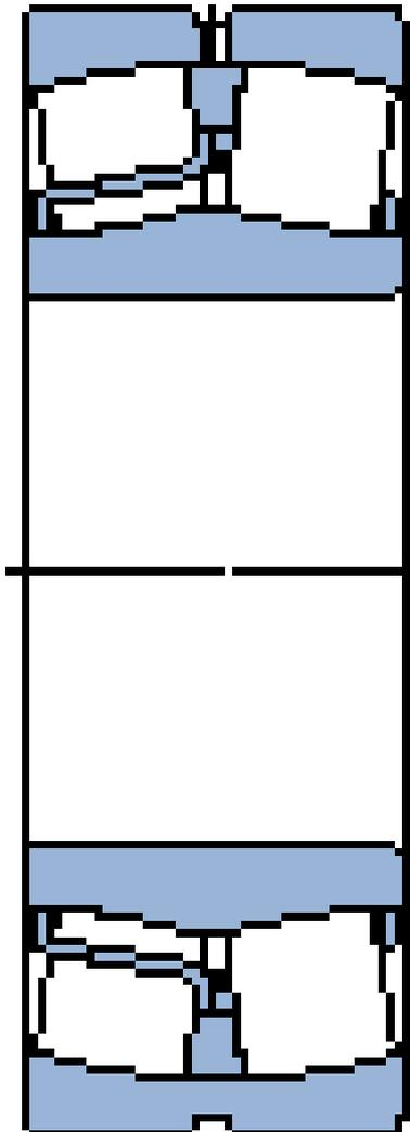
**22319 EWJA/VA405 SKF Pendelrollenlager für Vibrationsmaschinen**
